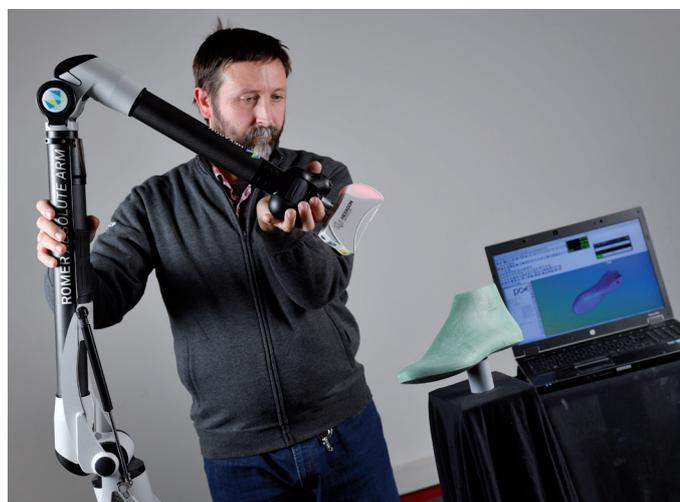
Servizi di scansione laser e ottica 3D per la ricostruzione in modello CAD 3D e verifiche dimensionali.
