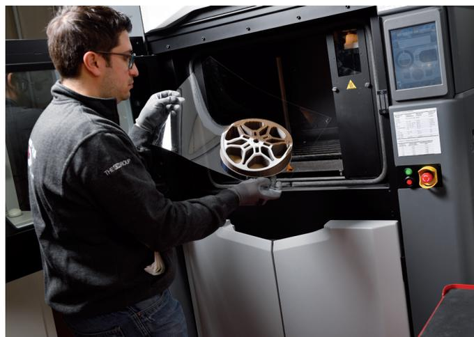
Service di stampa 3D con tecnologia FDM di vari materiali, quali ABS, PLA, nylon, Ultem e policarbonato.
